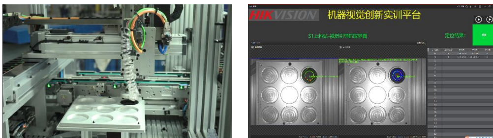
图 7a-上料环节-视觉引导抓取实践
